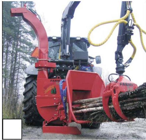
7.3 pav. Traktoriniai medienos smulkintuvai: 1 – NHS 960 (45 kW); 2 – CH 260 (70 kW; našumas iki 40 m 3 /h).
