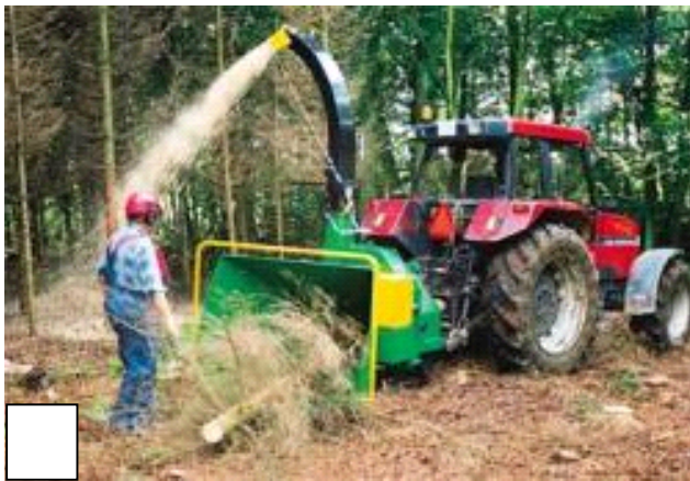
7.3 pav. Traktoriniai medienos smulkintuvai: 1 – NHS 960 (45 kW); 2 – CH 260 (70 kW; našumas iki 40 m 3 /h).
